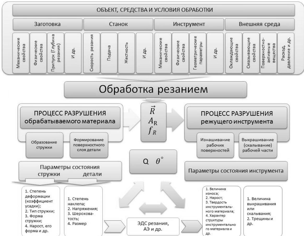
Рис. 3. Взаимосвязь параметров в процессе резания
