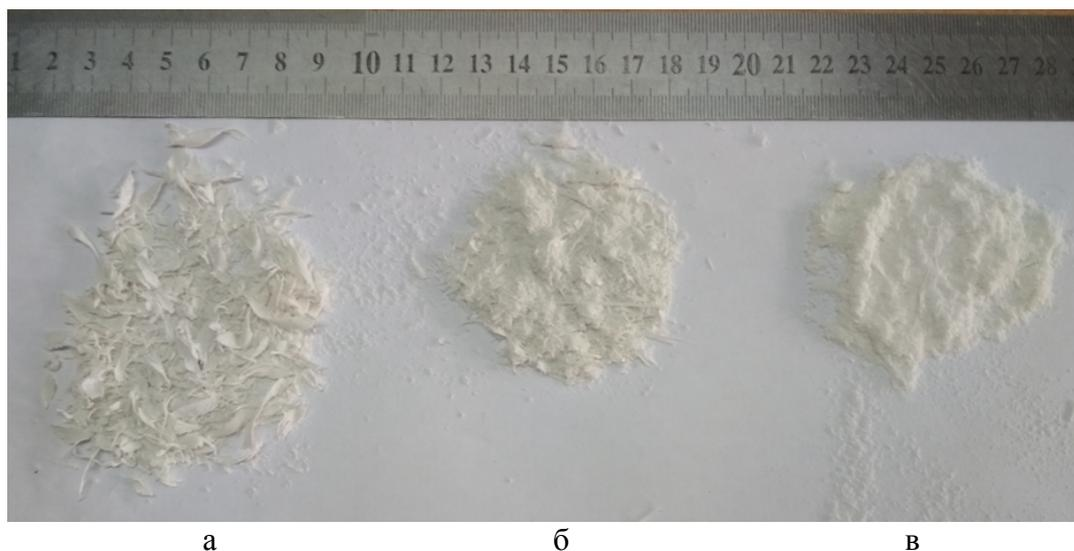
Рис. 3. Виды стружки на различных стадиях износа фрезы: а - остригаточенный инструмент; б - износ по задней поверхности от 0,15 до 0,25мм; в - износ по задней поверхности от 0,25 до 0,35 мм.
